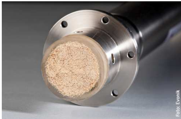
Vue en coupe d'une membrane Evonik Source : MT- Biomethan
